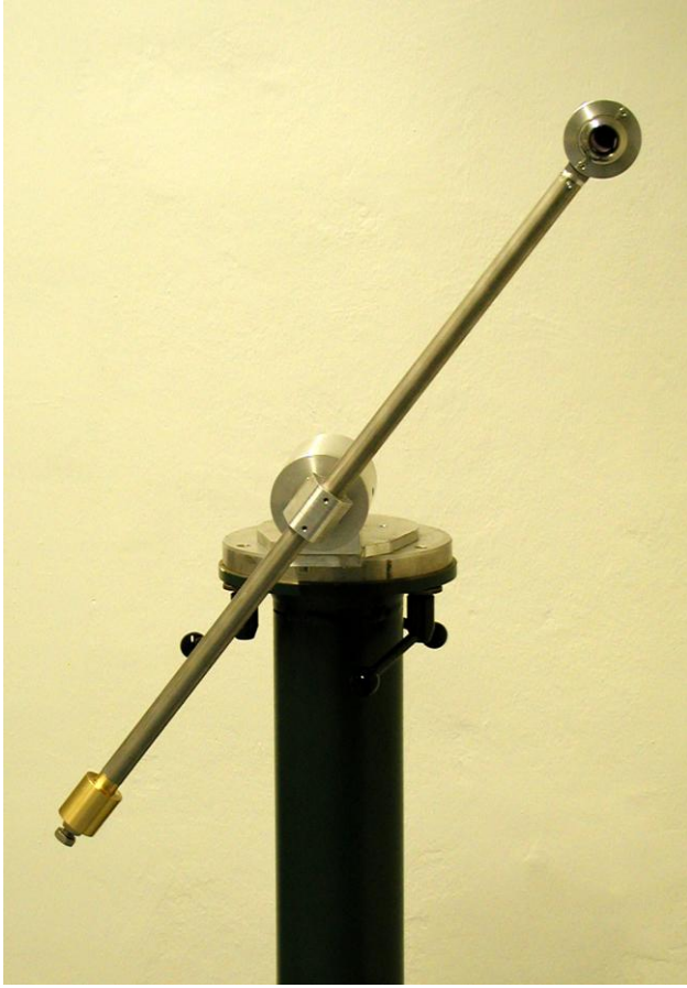
Abb. 8: GIK-Eigenkonstruktion der Ballbar
