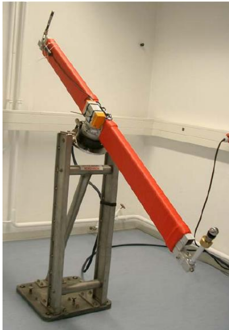
Abb. 1: Ti4CalibS des GIK, mit Komponenten des iGPS (oberes Ende und Mitte des Dreharms) und CCR (unteres Ende, optional, für simultane Vergleichsmessungen mit dem Lasertracker)
