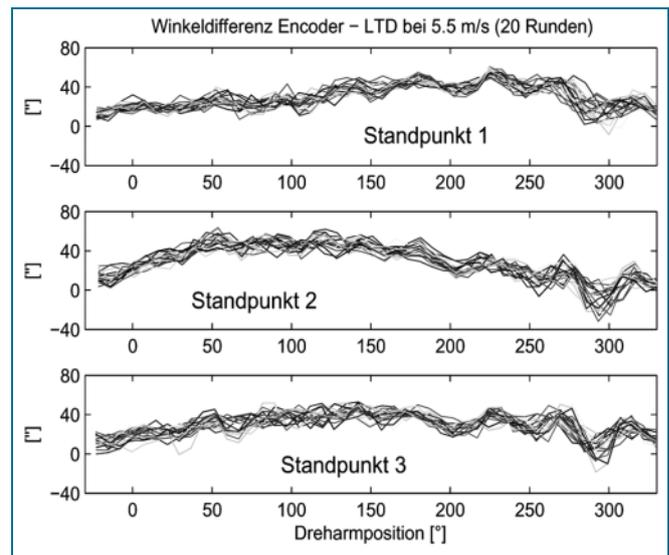
**Bild 7:** Winkeldifferenz Drearm-Encoder – LTD bei 5,5 m/s
