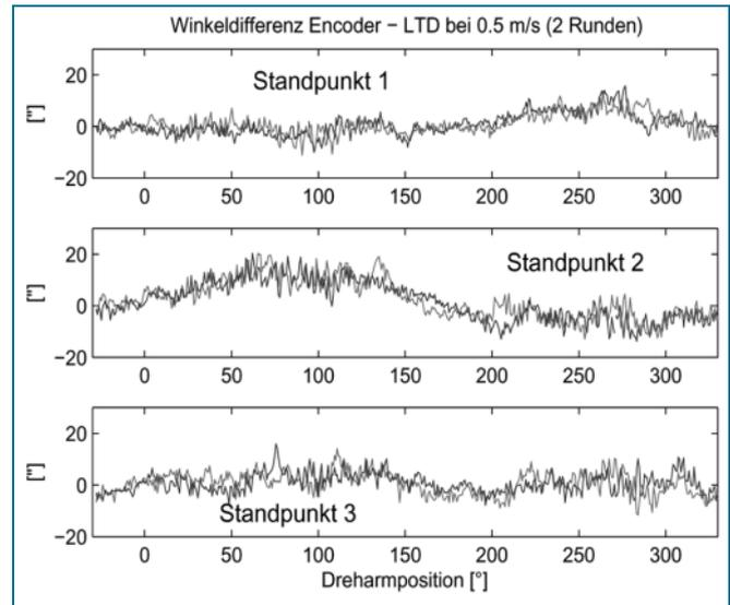
**Bild 5:** Winkeldifferenz Drearm-Encoder – LTD bei 0,5 m/s:
