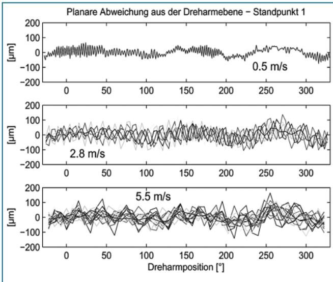
**Bild 4:** Planare Abweichungen aus der Dreherebene bei verschiedenen Geschwindigkeiten (Standpunkt 1)
