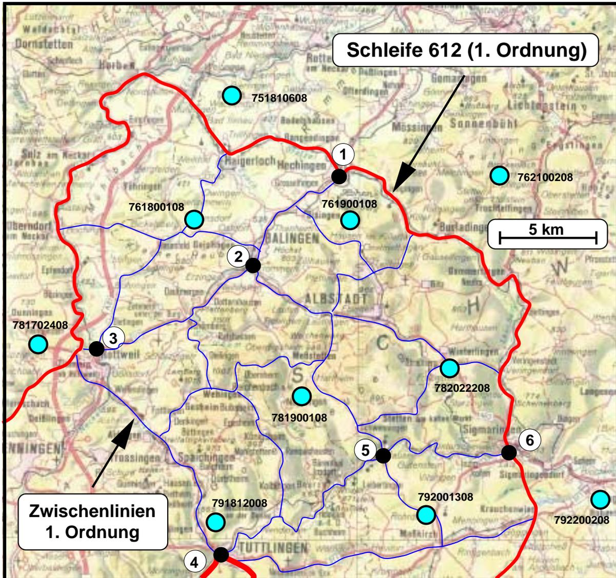
**Abbildung 4:** Netzübersicht des Teilprojektes B zur Überwachung von Nivellements-knotenpunkten (helle Kreise: 10 BWREF-Punkte im Meßgebiet, schwarze Kreise: zu überprüfende Knotenpunkte)
