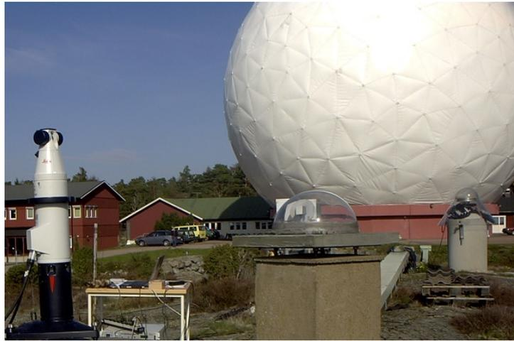
Abbildung 1: IGS-Referenzstation und Radom des VLBI-Radioteleskops
